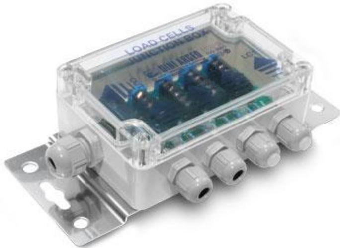
Anschlusskasten, IP67, ausgestattet mit einer Platine für Anschluss und Abgleich von 2, 3 oder 4 Wägezellen. Schraubbare Klemmleisten für einen einfachen Anschluss der Messleitungen und Abgleichwiderstände für einen genauen und zuverlässigen Eckenabgleich.
